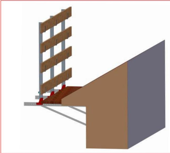
In alternativa alle tavole in legno per il camminamento, si possono usare le tavole zincate per ponteggio rispettando i limiti massimi di interesse previsti dal parapetto.
