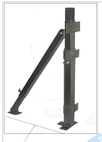
Max ingombro 72 cm Staffa di sostegno per tavole, utile per realizzare muri perimetrali, cordoli o piastre in c.a. (solette e platee). Questo articolo sostituisce il laborioso lavoro di carpenteria del legno necessario per realizzare la cassaforma, riducendo il tempo impiegato e lo spreco di legname.
