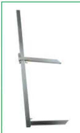
Articolo ideato per realizzazione delle fondazioni, utile per il sostegno dei pannelli durante il getto. Viene fissato mediante un cuneo.
